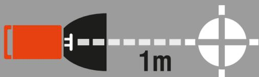
Dados obtidos a partir de 1 metro de distância com refletor parabólico. Potência em Watts nominal.
