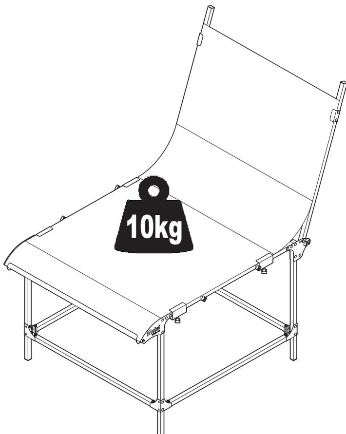
A figura ao lado mostra a Mesa TT100-N2 montada. Recomenda-se que o(s) objeto(s) a serem fotografados não ultrapassem o peso de **10kgs** afim de evitar danos por sobrecarga da **Chapa Plástica para Fundo Infinito N**. As **Barras de Reforço G** podem ser removidas quando o(s) objeto(s) tiver(em) peso inferior a **1kg**.
