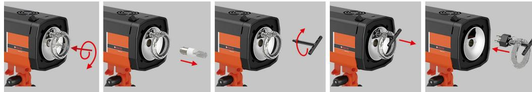
O Mako Socket System® permite ao usuário efetuar a troca da lâmpada, de flash ou modelagem, sem a necessidade de assistência técnica.
